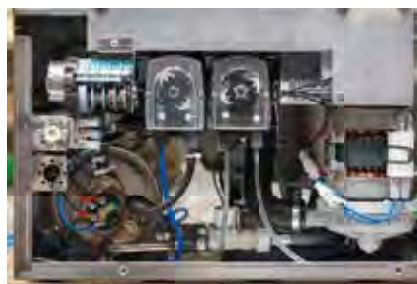
Dosificador detergente peristáltico y temporizador estándar para toda la gama
