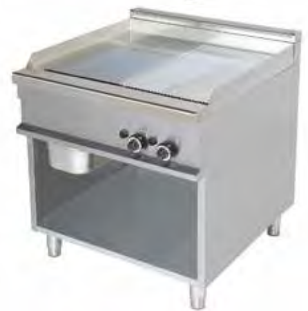
GG- 931-SG mitad lisa- mitad ranurada GAS CONSUMO: GN - NATURAL: 1,56 m³/h. LPG-PROPANO: 1,18 Kg./h.
