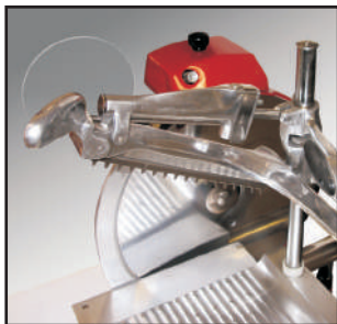
Brazo articulado para una perfecta sujeción del producto.
